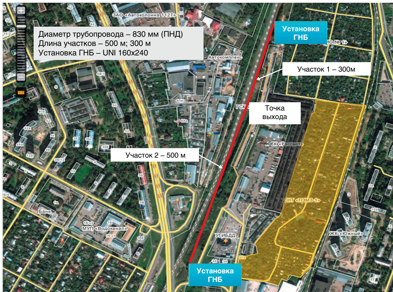
Рис. 4. СХЕМА ТРАССЫ ОБЪЕКТА: «СТРОИТЕЛЬСТВО ЛИВНЕВОЙ КАНАЛИЗАЦИИ ДЛЯ ПУТЕПРОВОДА ЧЕРЕЗ ПУТИ МОСКОВСКОЙ ЖД»
