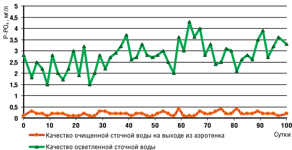
Рис. 11. Результаты удаления фосфора в аэротенке экспериментальной линии
