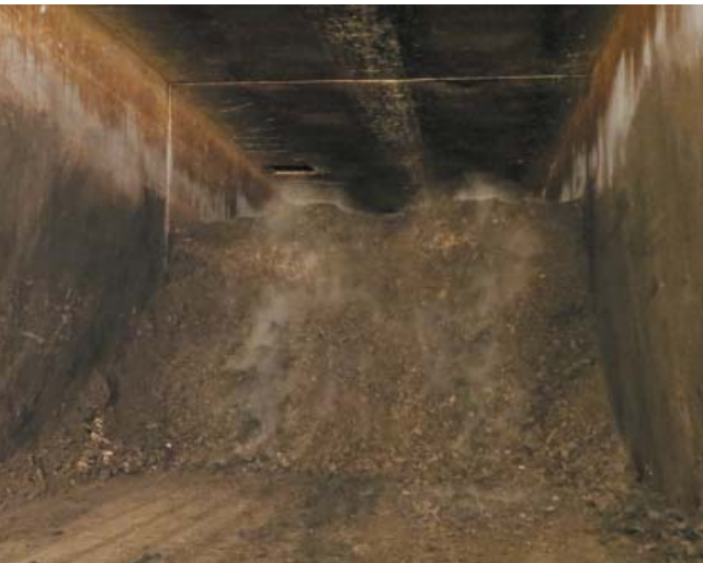
Рис. 4. Туннель (камера) КОМПСТИРОВАНИЯ ОСАДКА, TIEL (НИДЕРЛАНДЫ)
