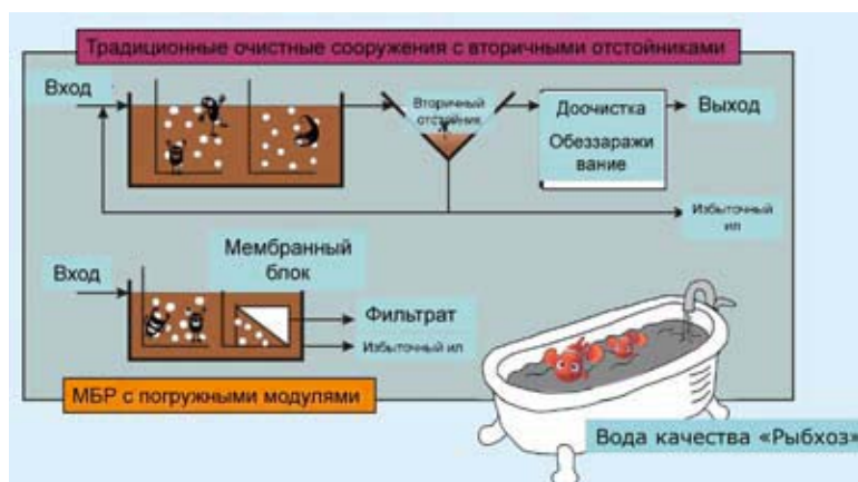
Рис. 1. Отличие традиционных сооружений от МБР
