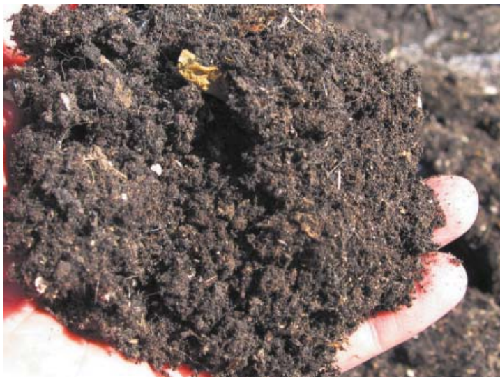
Рис. 4. Высушенный осадок: легкая, проницаемая структура
