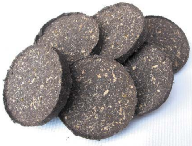
Рис. 5. Опытные образцы топливных брикетов из осадка
