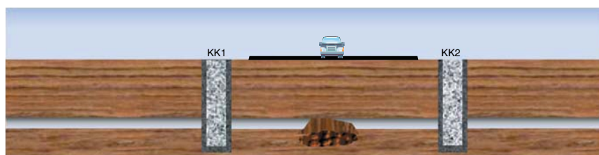
Рис. 18. РЕМОНТ АВАРИЙНОГО УЧАСТКА КАНАЛИЗАЦИИ КОМБИНИРОВАННЫМ МЕТОДОМ: ГНБ + ПНЕВМОПРОБОЙНИК
