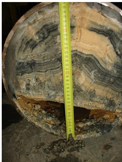
Отложения карбоната кальция в трубопроводе после 15 лет эксплуатации
