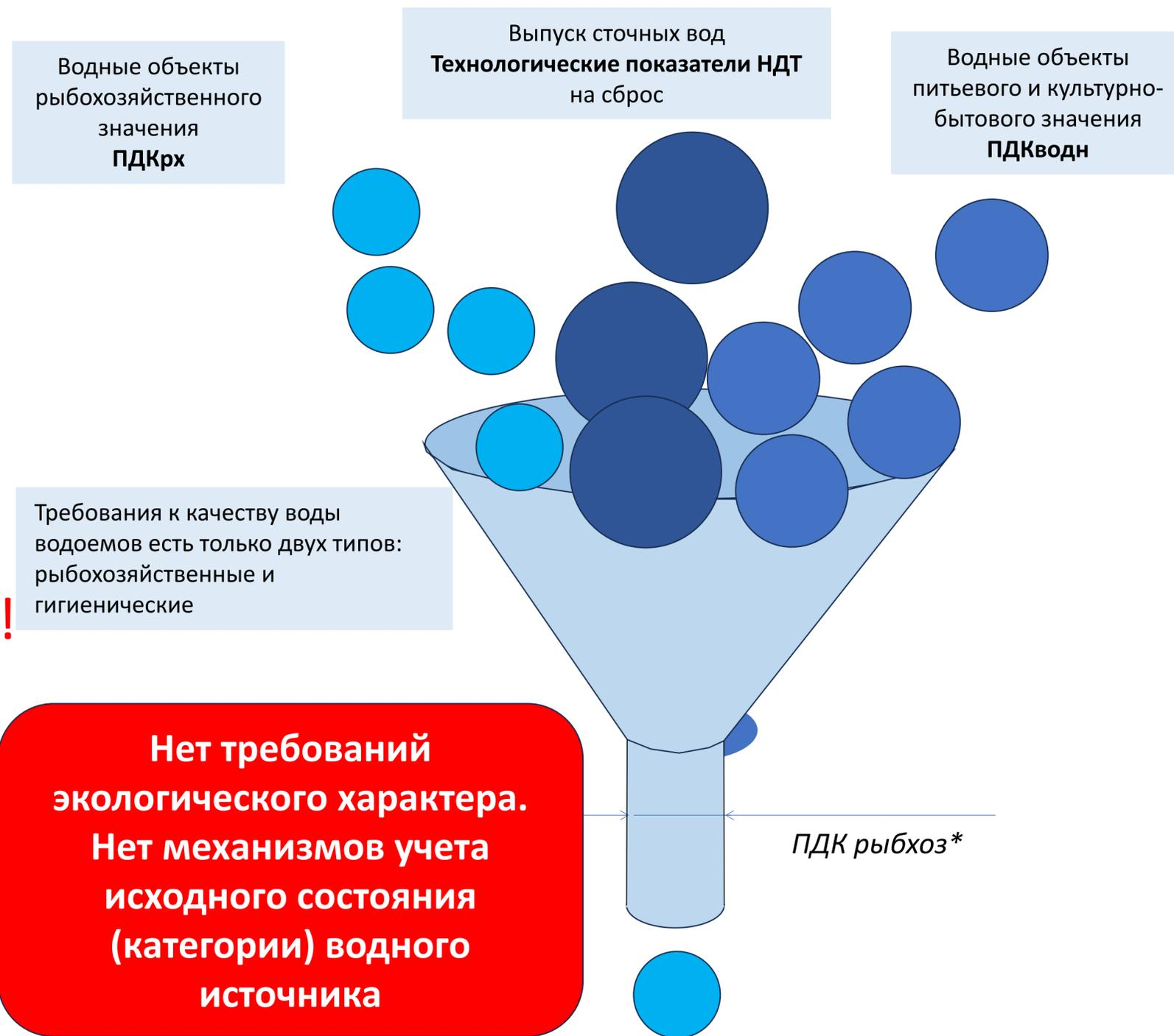
В настоящее время дифференциация требований к качеству стоков относительно качества воды в водоисточнике, куда осуществляется сброс очищенных сточных вод, есть только для очистных сооружений ЦСВ ПГО\*\* - Технологические показатели наилучших доступных технологий (ТП НДТ)
