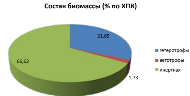
Рисунок 2 Распределение состава биомассы ила для типичной городской сточной воды (по данным расчета на модели GPS-X).
